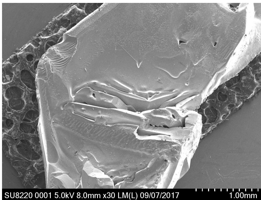
Рисунок 62 – Снимок СЭМ кристалла, выбранного для рамановских исследований
